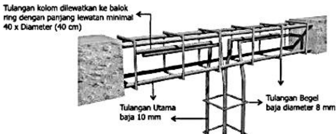
Gambar 3. 29 Hubungan Antara Kolom dengan Balok Keliling/Ring
