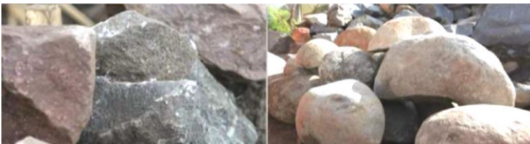
Gambar 3. 5 Kualitas Batu Kali/Gunung yang Baik Digunakan sebagai Pondasi
