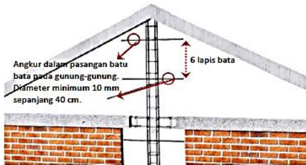
Gambar 3. 31 Hubungan Antara Tulangan Bingkai Gunung-Gunung/Ampig dengan Tulangan Kolom dan Balok Keliling/ Ring
