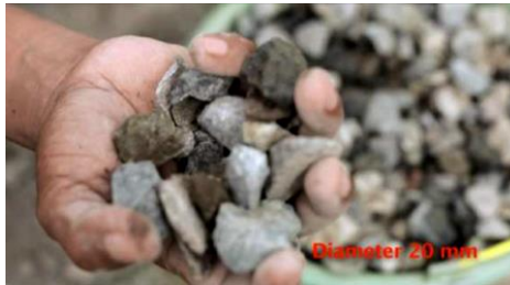
Gambar 3. 4 Diameter Kerikil yang Baik untuk Campuran Beton
