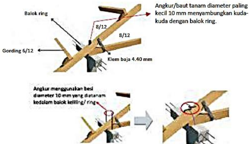
Gambar 3. 30 Hubungan Antara Balok Keliling/Ring dengan Kuda-Kuda Kayu
