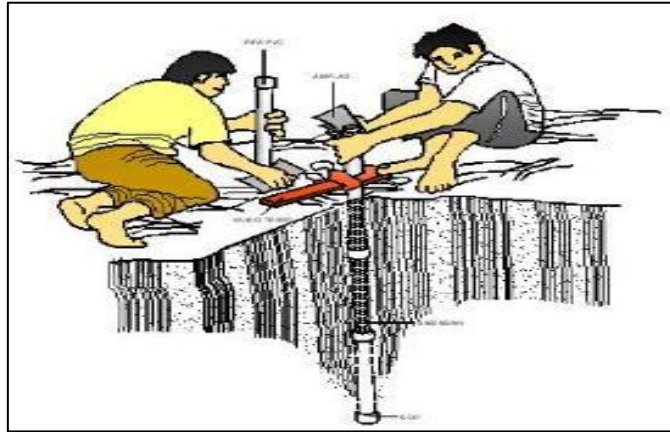
Gambar III.20. Pemasangan dan Penyambungan Pipa Hisap
