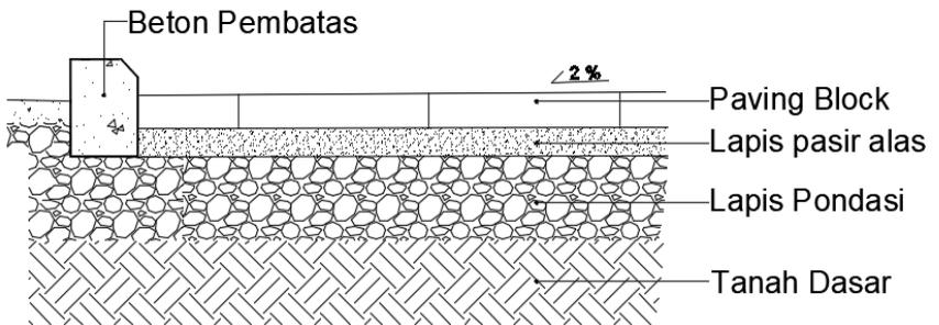
Gambar 3.19 Susunan Perkerasan Jalan Paving Block
