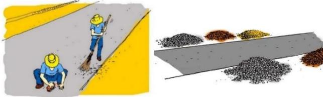
Gambar 3.10 Pembersihan Permukaan Aspal
