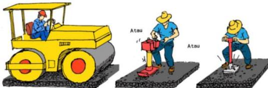
Gambar 3.21 Pemadatan Lapis Pondasi Agregat
