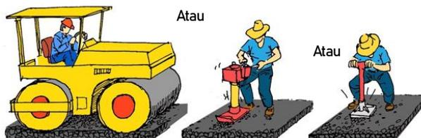
Gambar 3.14 Proses Pemadatan Aspal
