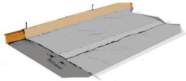
Gambar 3.23 Pemasangan Membran
