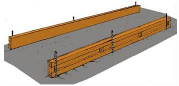
Gambar 3.22 Pemasangan Bekisting
