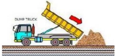
2. Penghamparan timbunan dengan menempatkan material timbunan ke permukaan yang sudah disiapkan dan disebar dengan merata dengan ketebalan gembur 15 (lima belas) centimeter sehingga akan memenuhi toleransi tebal lapisan yang disyaratkan.
