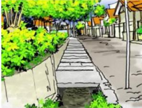
Gambar III.7 Saluran Terbuka Yang Ditutup Plat Beton
