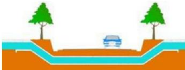
Gambar 3. 14 Bangunan Siphon Drainase
