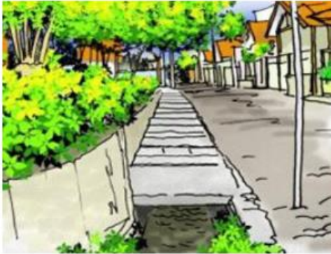
Gambar 3. 7 Saluran Terbuka Yang Ditutup Plat Beton Sumber: 12/PRT/M/2014 tentang Penyelenggaraan System Drainase Perkotaan, Peraturan Menteri Pekerjaan Umum
