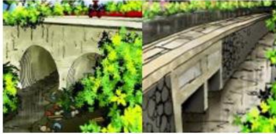
Gambar 3. 12 Bangunan Gorong-Gorong Sumber: 12/PRT/M/2014 tentang Penyelenggaraan System Drainase Perkotaan, Peraturan Menteri Pekerjaan Umum
