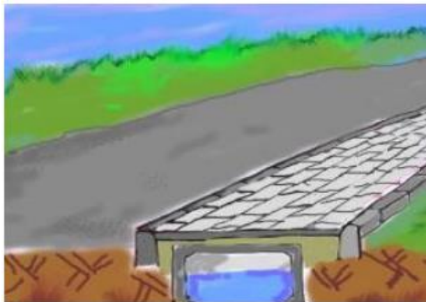
Gambar 3. 8 Saluran Tertutup Sumber: 12/PRT/M/2014 tentang Penyelenggaraan System Drainase Perkotaan, Peraturan Menteri Pekerjaan Umum
