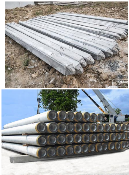
Gambar 2.17 Pondasi Tiang Pancang Beton
