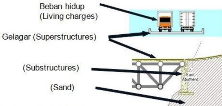
Sumber: "Teknik Dasar Konstruksi Jembatan", Ir. Moh. Tontro Prastowo, MT
