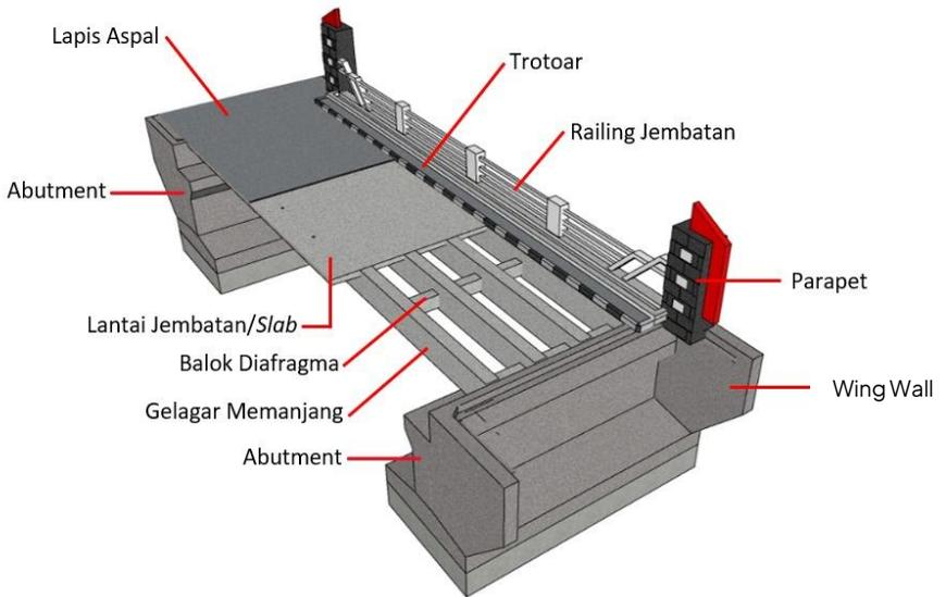
**Gambar 2. 1** Bagian-Bagian Jembatan
