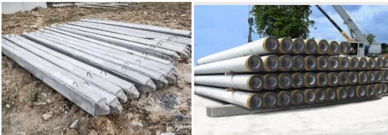
**Gambar 2. 17** Pondasi Tiang Pancang Beton
