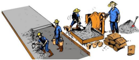
Gambar 3.17 Pencampuran dan Pengecoran Beton
