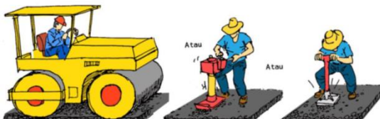
Gambar 3.11 Pemadatan Lapis Pondasi Agregat
